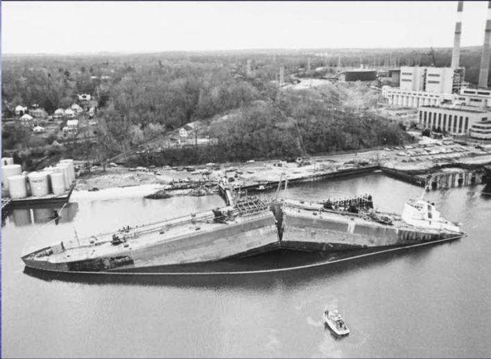
Esso Manhattan , petrolero T-2 de 11000 TRB, fracturado espontáneamente a su entrada en el puerto de Nueva York . en Marzo de 1943.
